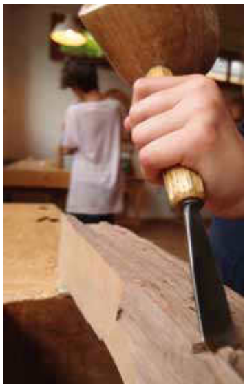
Die Kontur wird ausgestemmt.
